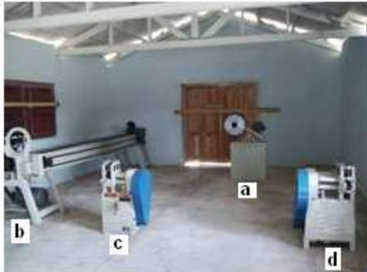
Figura 12: Equipamiento para obtener las cintas de bambú.
