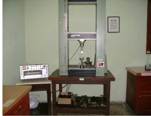
Figura18 : Dinamómetro Universal Alwetron TCT-10.
