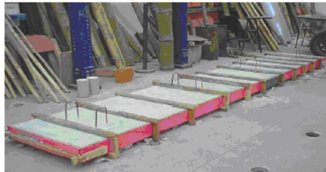
**B- Losa de hormigón reforzada con bambú tras ser fraguada**
