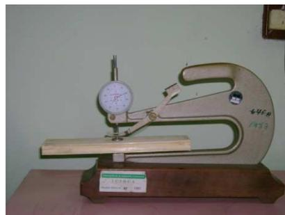
Figura 17: Medidor de espesor con indicador.
