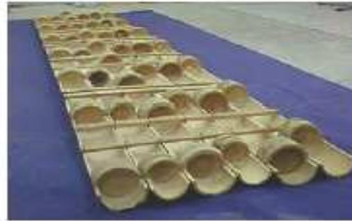
**Refuerzos de bambú con membrana completa a modo de conector.**
