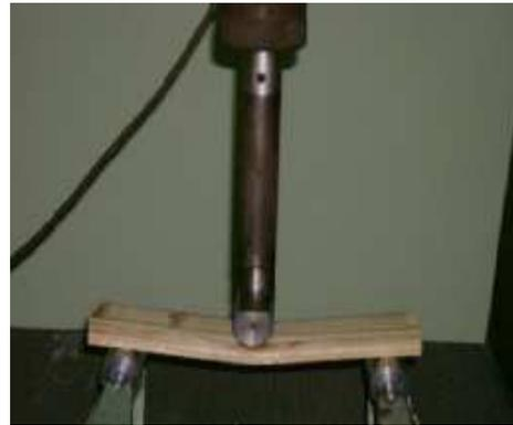
Figura 16: Ensayo a flexión en el dinamómetro Alwetron TCT10
